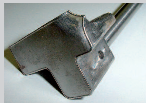
Rechargement par soudure sur arêtes d'étanchéité usées (Photo : L&A Lasertechnik, Radebeul)
