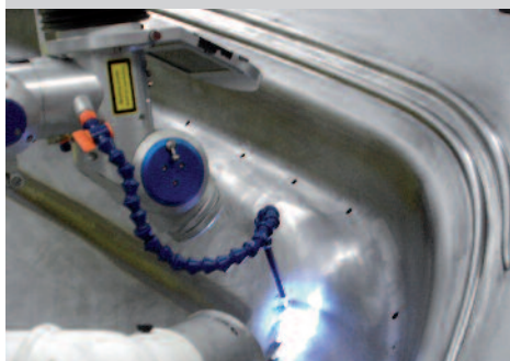
Soudage de réparation (photo : PML Lasertechnik, Nohra)
