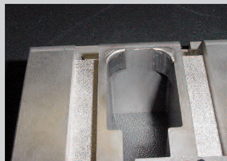
Modification du rayon de la matrice d'une presse à découper en 1.2379 (photo : L&A Lasertechnik, Radebeul)
