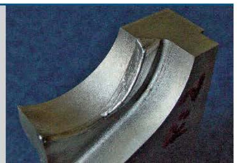
Modification du contour 1.2767 (Photo : L&A Lasertechnik, Radebeul)
