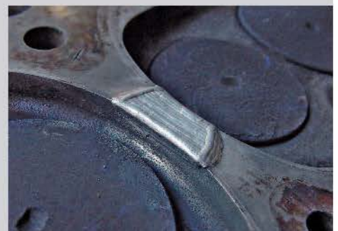
Réparation d'une culasse refroidie à l'eau en aluminium (photo : L&amp;A Lasertechnik, Radebeul)
