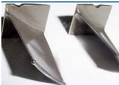
Amélioration des contours endommagés d'aubes de turbine (photo : L&A Lasertechnik, Radebeul)
