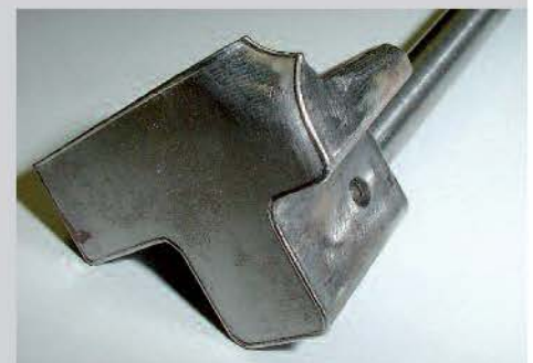
Redchargement par soudure sur arêtes d'étanchéité usées (Photo : L&A Lasertechnik, Radebeul)
