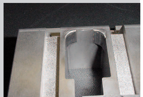
Modification du rayon de la matrice d'une presse à découper en 1.2379 (photo : L&amp;A Lasertechnik, Radebeul)
