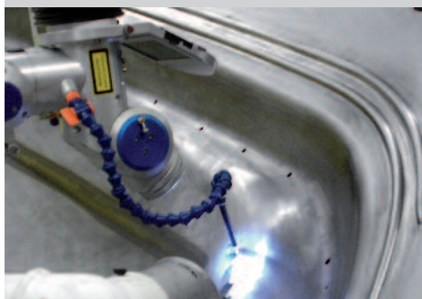
Soudage de réparation (photo : PML Lasertechnik, Nohra)
