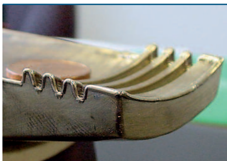
Restauration des arêtes d'étanchéité usées d'un insert de moule en bronze Ampco (photo : L&A Lasertechnik, Radebeul)
