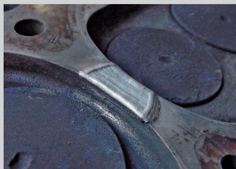
Réparation d'une culasse refroidie à l'eau en aluminium (photo : L&A Lasertechnik, Radebeul)
