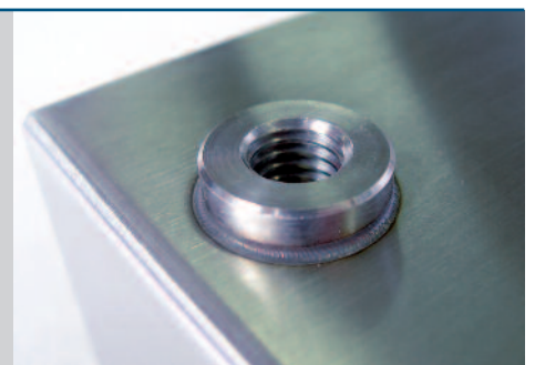
Boîtier en acier inoxydable, soudure circulaire (Photo : HAKAMA AG, Schweiz)
