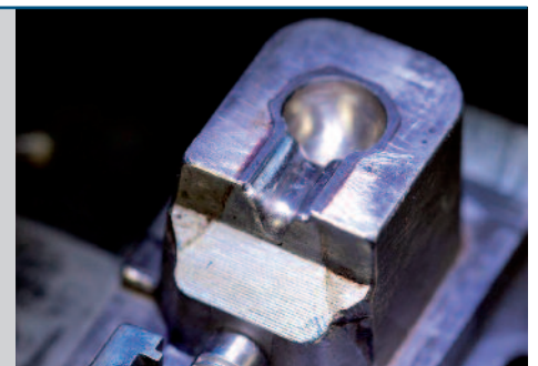
Insert de moule pour moulage à injection (Photo : Grübel KG, Tabarz)
