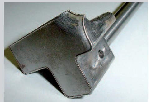
Rechargement par soudure sur arêtes d'étanchéité usées (Photo : L&A Lasertechnik, Radebeul)
