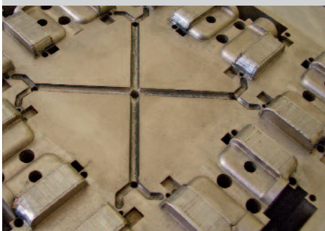
Modification des contours d'un moule de fonderie à huit canaux par rechargement par soudure (photo : Jutz Lasertechnik GmbH, Wien)
