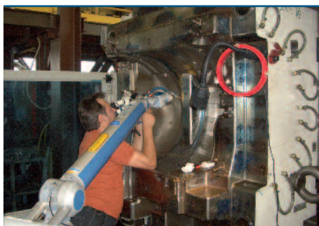
Soudage de réparation mobile dans la machine sur pièce moulée par injection (photo : Jutz Lasertechnik)
